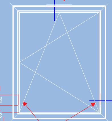
100 мм от нижнего угла рамы вырезается 150 мм уплотнителя с обоих сторон. Возникает воздушный канал связывающий наружную атмосферу с воздухом в помещении.
